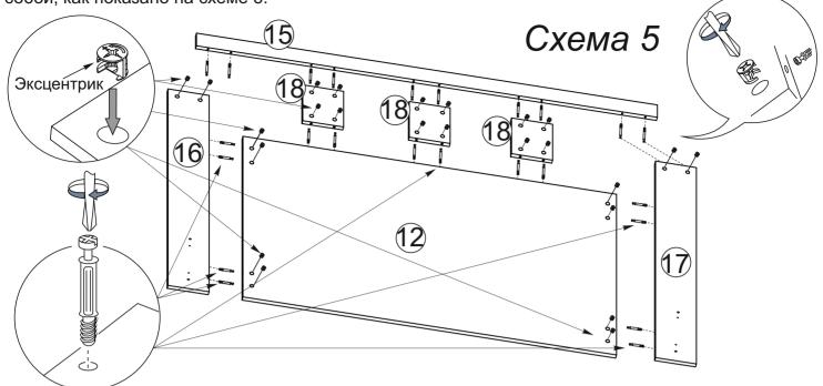
7. Далее в собранный головной щит и ножной щит №13 установите штоки эксцентриковой стяжки (отверстия диаметром 5 мм) и шканты (отверстия диаметром 8 мм). Затем присоедините щиты к собранному ранее каркасу и закрепите их эксцентриковой стяжкой, как показано на схеме 6. Обратите внимание, что отверстия под крепление щитов (шканты и эксцентриковые стяжки) просверлены одинаково. Поэтому перед сборкой определитесь, с какой стороны необходимы ящики. В зависимости от вашего выбора закрепите щиты.
